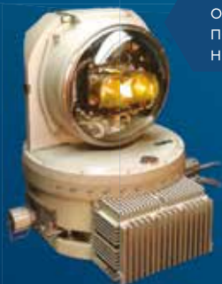
ИСОН спутниковый компас с инерциальной поддержкой
